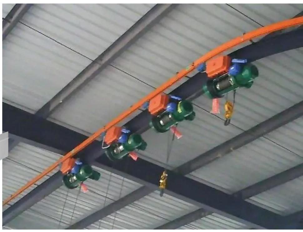
▲管式密封滑触线应用于集成度要求严苛、密封良好工况，外壳分为塑壳、铝壳和复合材料外壳，可集成到10极使用，负荷电流可达30~250A。
