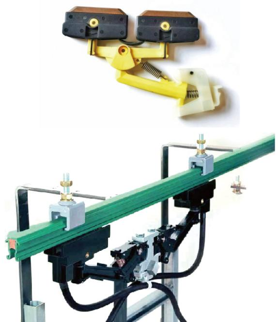
▲单极组合滑触线用途广泛,设计安装简捷,多极按需组合;导体可以是铜材、铝芯不锈钢、镀锌钢和不锈钢等,允许电流可达10~1600A。
