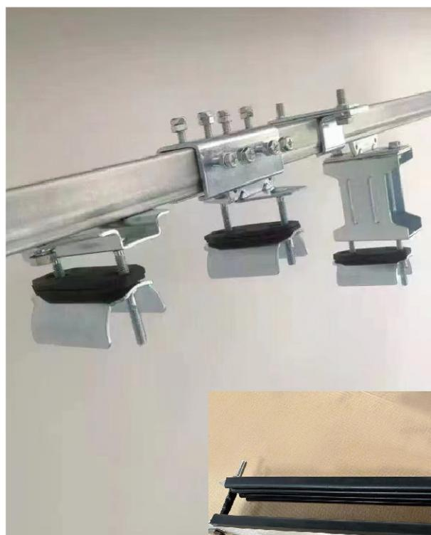
▲C型轨道系列滑车,轨道分30、40、50三种尺寸系列,承重开口有进口及国产两种样式;每种轨道可有不同材质和壁厚供选择;单车承重最高可达150Kg,运行速度可达120米/分钟。
